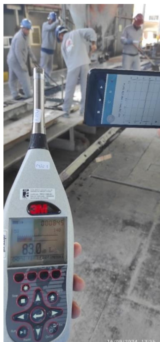
Figura 8 – Posicionamento dos instrumentos pareados durante a medição do ruído
