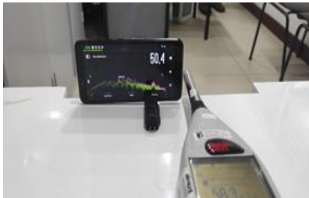
Figura 7 – Smartphone com microfone na parte inferior
